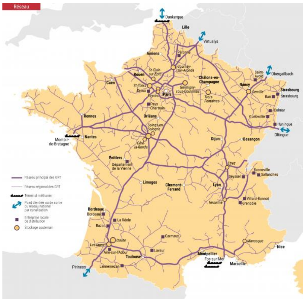
Figure 25 - Le réseau de transport du gaz en France, Source : Commission de régulation de l'énergie 2019
