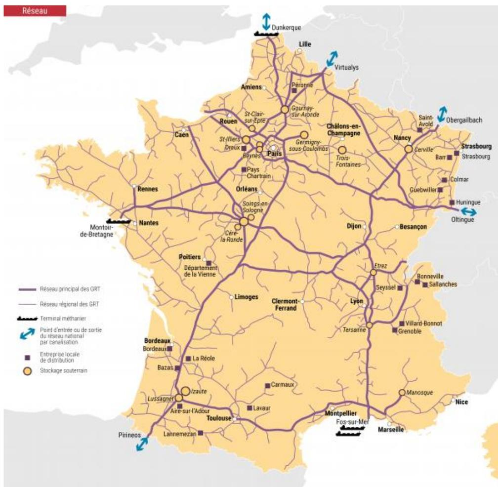
Figure 27 - Le réseau de transport du gaz en France, Source : Commission de régulation de l'énergie 2019
